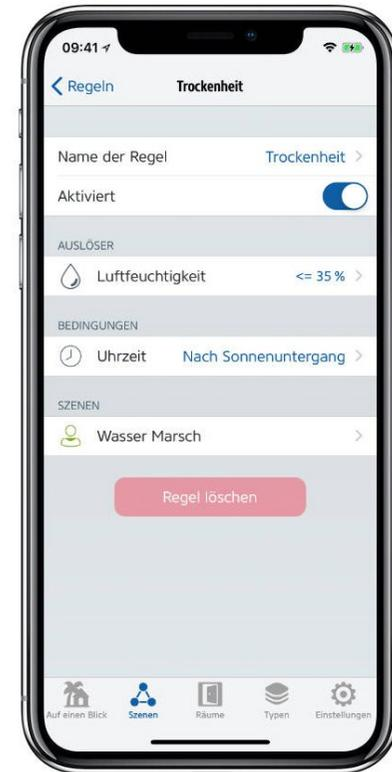
Zeitpläne, die Eve Aqua zu bestimmten Tageszeiten automatisch aktivieren, lassen sich mit der Eve App einfach und schnell anlegen und an das Gerät senden; die Bewässerung läuft so unabhängig vom Standort des iOS-Geräts oder der Steuerzentrale. Es lassen sich mehrere gleichzeitig aktive Zeitpläne anlegen, etwa für Wochentage und das Wochenende. Ein Tipp: Wer die Flussrate seines Bewässerungssystems kennt, etwa aus der Dokumentation oder durch einminütiges Auffan-
